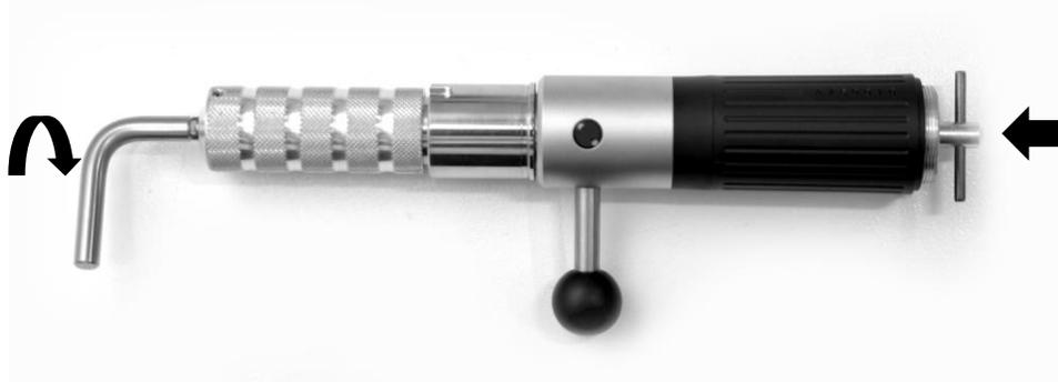
Spannzange reinigen, außen leicht einfetten und in die Welle einsetzen. Mit Schlüsseln wie oben beschrieben die Spannzange im Uhrzeigersinn bis zum Endanschlag einschrauben und leicht anziehen. Steckkörper aufstecken und mit Kappe verschrauben. Frässpindel wieder in Spindelhalterung einsetzen.
